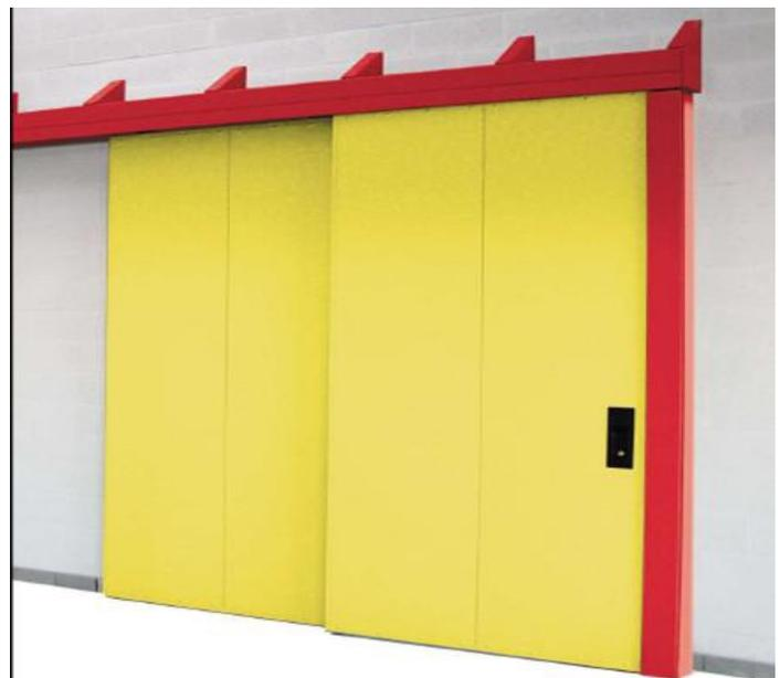
**Guía Corredera:** Horizontal bidireccional, realizada en chapa de acero doblada, pre-dispuestas a fijar los elementos por abrazaderas o por medio de compensadores. Deslizamiento aéreo con reductores de fricción. Pines rotatorios ocultos para el deslizamiento sobre el suelo.
